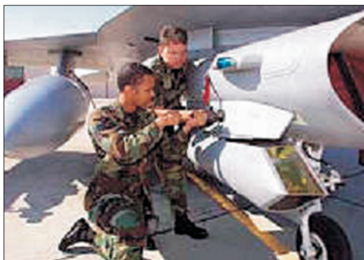
Вариант размещения подвешенного контейнера «Снайпер XR» на истребителе F-16C
