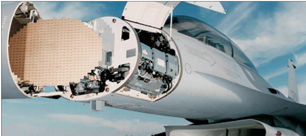
Размещение РЛС AN/APG-68(V)9 на самолете F-16
